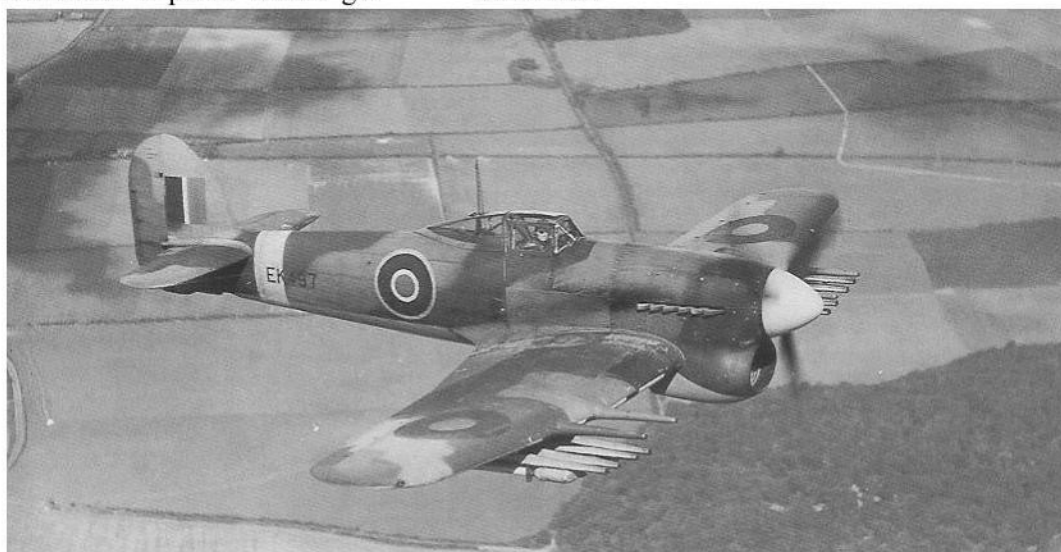
Een Typhoon MK IB met de klassieke tankbestrijdingsuitrusting met acht raketten aan lange langeerrails onder de buitenvleugels.
