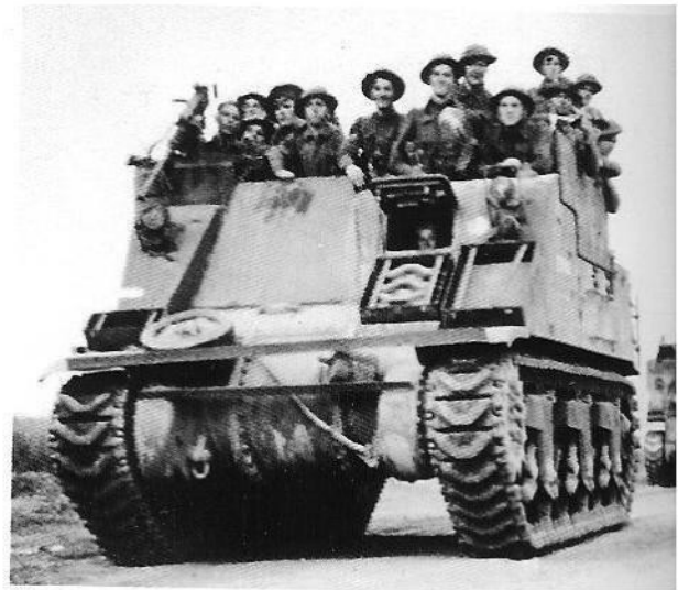
De eerste Kangeroos, hier tijdens operatie "Totalise", augustus 1944, waren gebaseerd op een aangepast chassis van een M7 gemechaniseerde houwitser.
