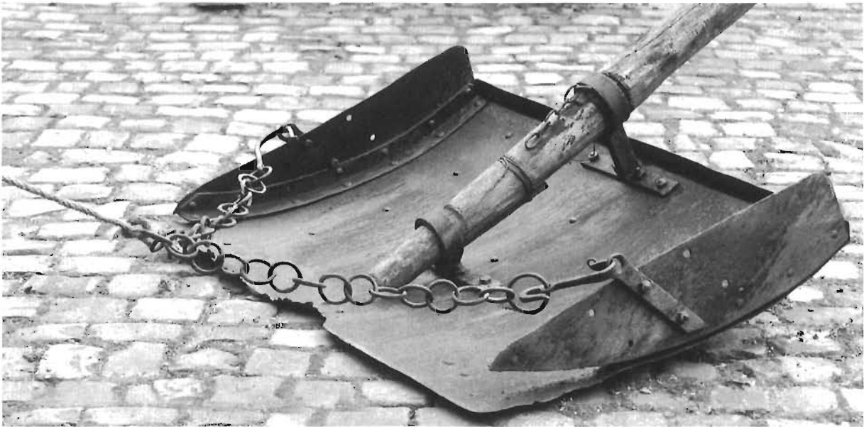
Molbord voor het verplaatsen en egaliseren van grond. Tot \pm 1960 in gebruik op boerderijen. Coll.: Museum Aanwas. In 16 e en 17 e eeuw gemaakt van hout.
