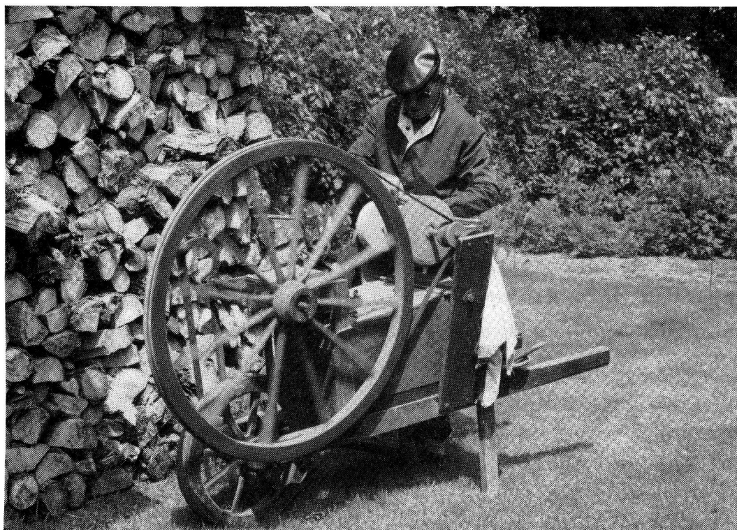
De scharenslijper aan het werk. Rechts hangt de doek, waarop de scharen na het slijpen werden uitgeprobeerd.
